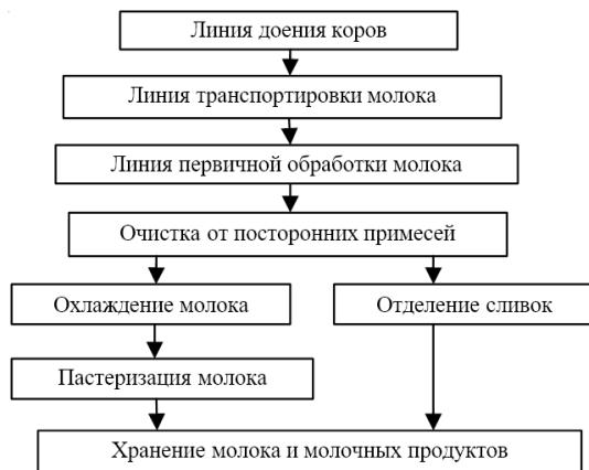
Рис. 6.1. Технологическая схема процесса доения коров и первичной обработки молока на молочной ферме
