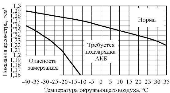
Рис. 3. Номограмма зависимости плотности электролита от температуры окружающего воздуха и разрядки аккумуляторной батареи
