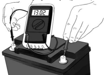
Рис. 4. Проверка аккумуляторной батареи мультиметром
