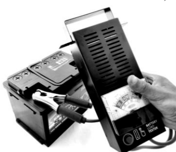
Рис. 5. Проверка аккумуляторной батареи анализатором состояния аккумуляторных батарей (нагрузочной вилкой)
