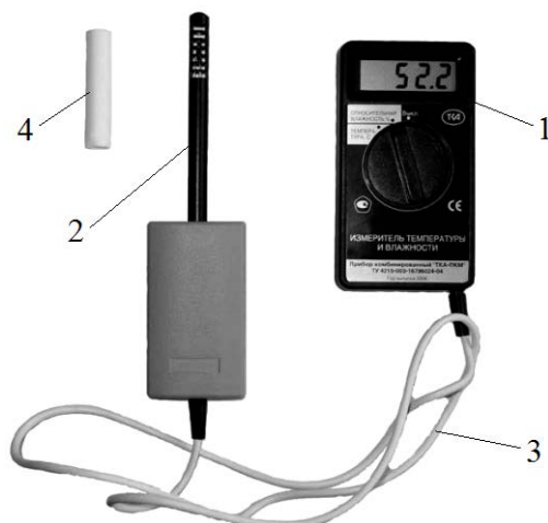
Рис. 4. Внешний вид прибора ТКА-ПКМ (модель 20): 1 – блок обработки сигналов; 2 – измерительная головка; 3 – кабель связи; 4 – защитный колпачок
