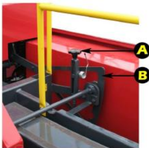
Рисунок 6.34 – Регулятор длины тюка
