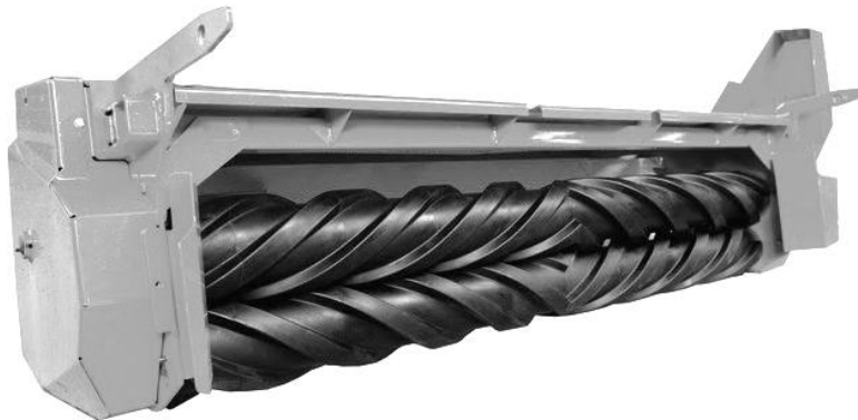
Рисунок 10.5 – Вальцовая плющилка косилки DISCO 2650 RC
