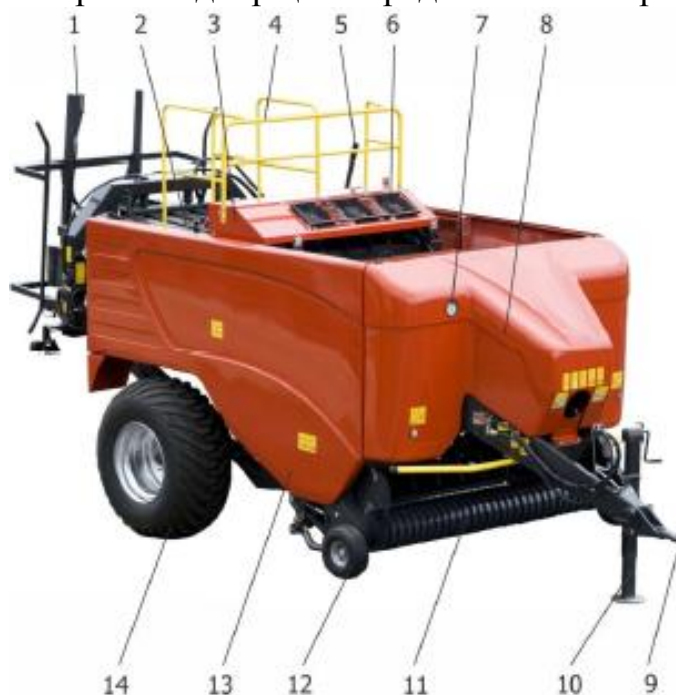
Рисунок 6.32 – Общий вид пресс-подборщика: 1 – желоб для выгрузки тюка; 2 – рычаг регулировки длины тюка; 3 – обвязывающий механизм; 4 – ограждение защитное; 5 – рычаг включения предкамеры; 6 – вентилятор; 7 – манометр; 8 – щит передний;; 9 – буксирная серьга; 10 – опора; 11 – подборщик; 12 – колесо подборщика; 13 – щит боковой; 14 – колесо
