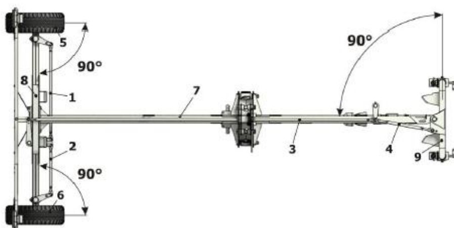
Рисунок 4.14 – Регулировка прямолинейности хода граблей 1, 2, 3, 4 – тяга; 5, 6 – колесо ходовое; 7 – балка средняя; 8 – балка задняя; 9 – навеска
