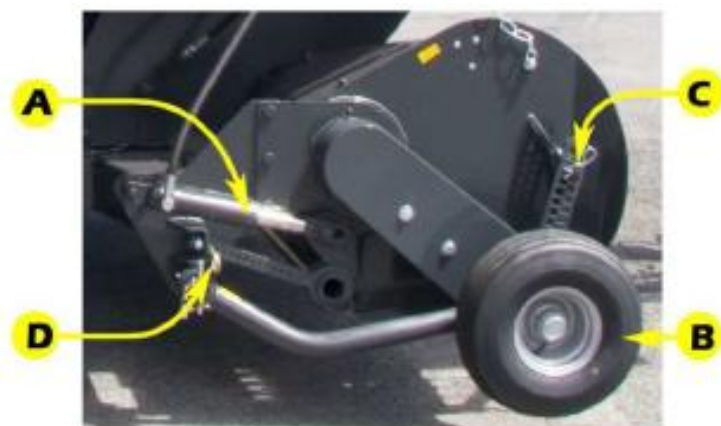
Рисунок 6.33 – Регулировка высоты подборщика
