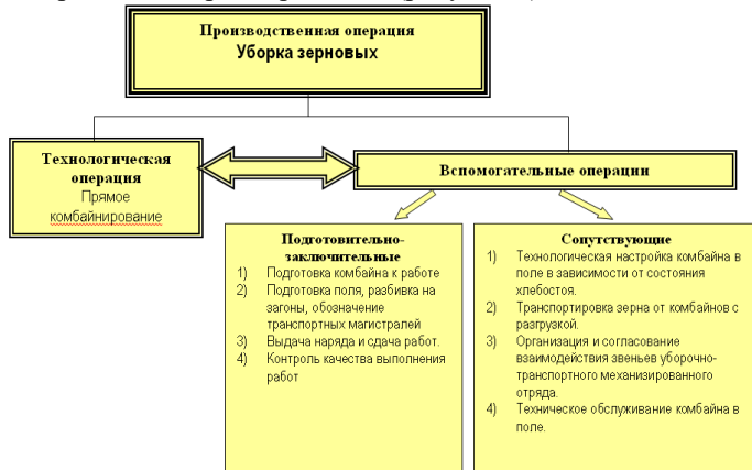
Рисунок 1. Структура производственной операции «Уборка зерновых».
