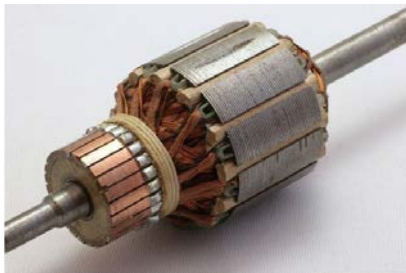
Рис. 4.5. Якорь машины постоянного тока
