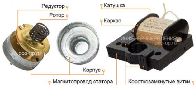
Рис. 3.15. Конструкция синхронного реактивно-гистерезисного электродвигателя
