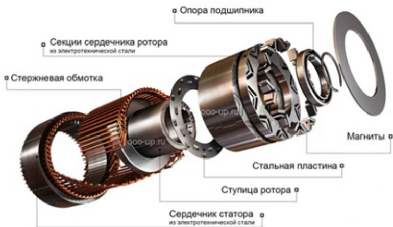
Рис. 3.7. Синхронный электродвигатель со встроенными постоянными магнитами
