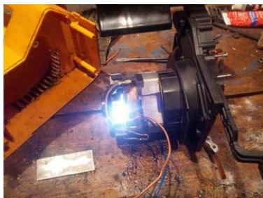
Рис. 4.20. Круговой огонь на коллекторе
