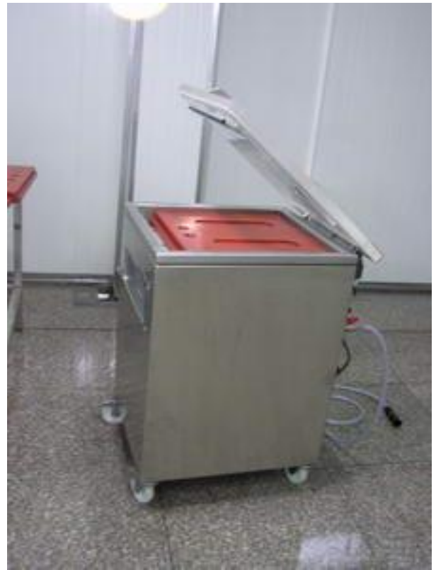
Рис. 38. Аппарат для вакуумного укупоривания банок. Съемные трафареты (красного цвета) позволяют использовать банки различной емкости
