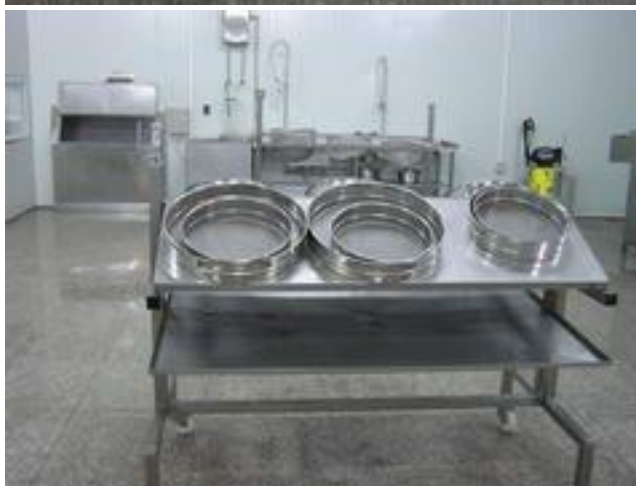
Рис. 33. Общий вид стола для пробивки икры. В таз, стоящий на нижней полке справа, падает зерно. Левый таз служит для сбора пробоек
