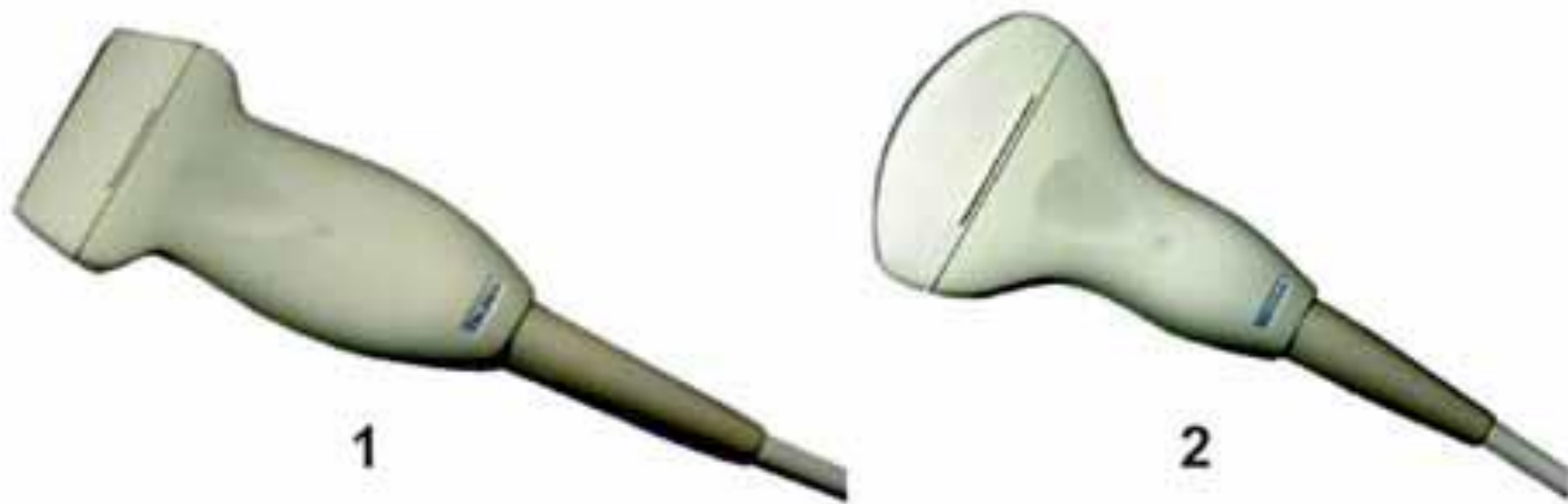
УЗИ датчики: 1 - линейный, 2 - конвексный
