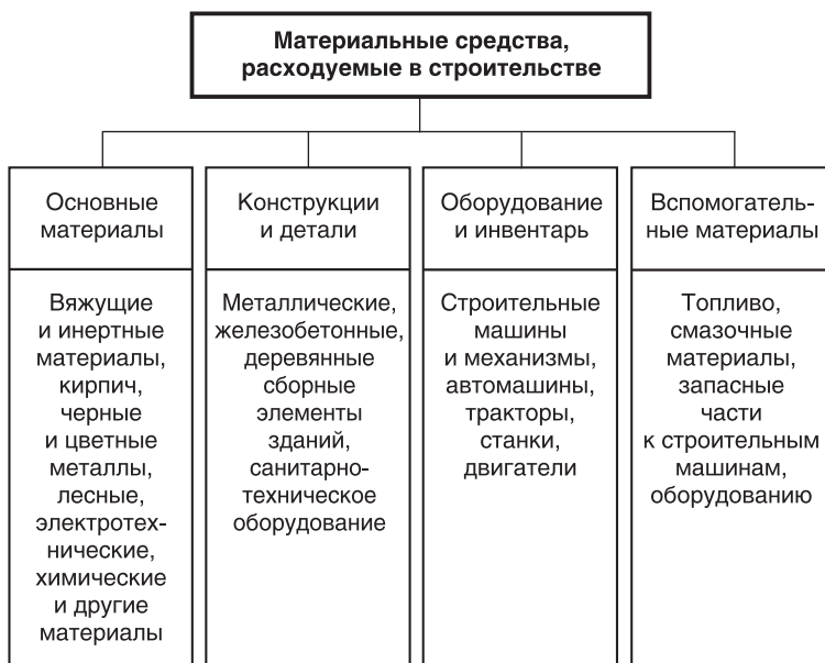
Рис. 4.9. Материально-техническое обеспечение строительного производства
