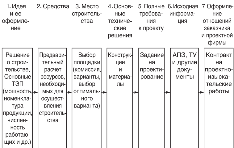
Рис. 3.10. Подготовка к проектированию производственных объектов
