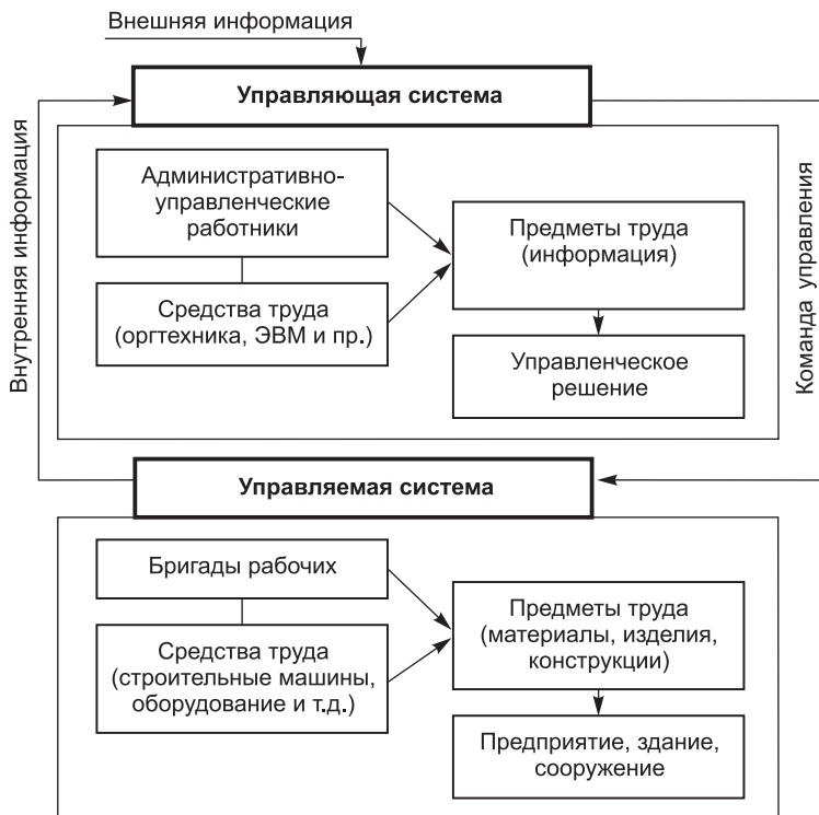
Рис. 2.4. Взаимодействие управляющей и управляемой систем в строительстве
