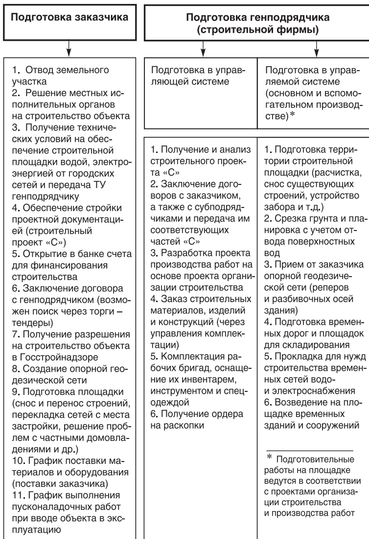
Рис. 4.10. Организационно-техническая подготовка к строительству
