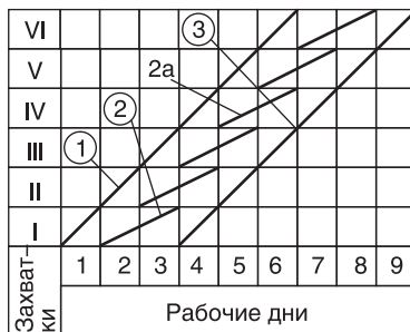
Рис. 4.24. Линейный график (а) и циклограмма (б) при кратноритмичном потоке
