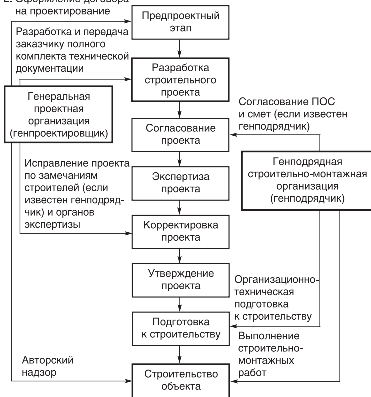
Рис. 3.14. Участие генпроектировщика и генподрядчика на различных этапах проектно-строительного цикла
