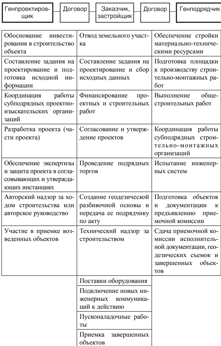
Рис. 4.5. Традиционные функции, выполняемые заказчиком, генпроектировщиком и генподрядчиком
