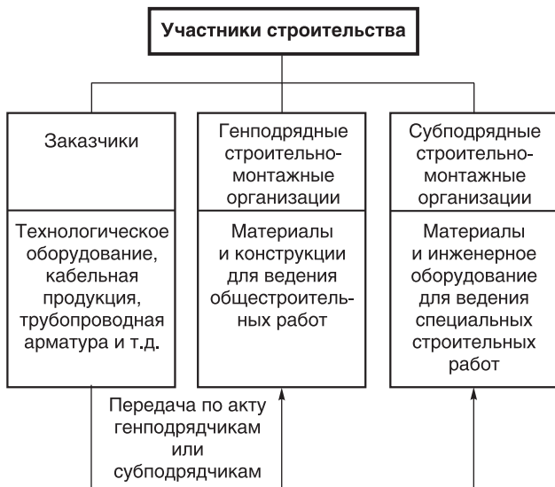
Рис. 4.27. Распределение поставок материально-технических ресурсов между участниками строительства
