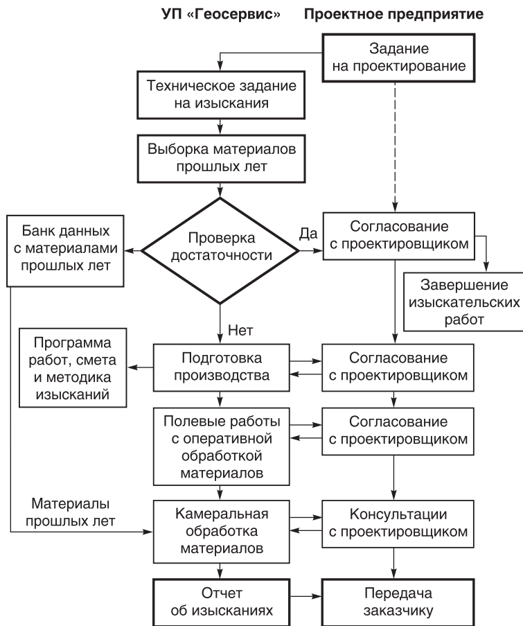
Рис. 3.8. Связи проектного предприятия с УП «Геосервис» в процессе выполнения инженерных изысканий
