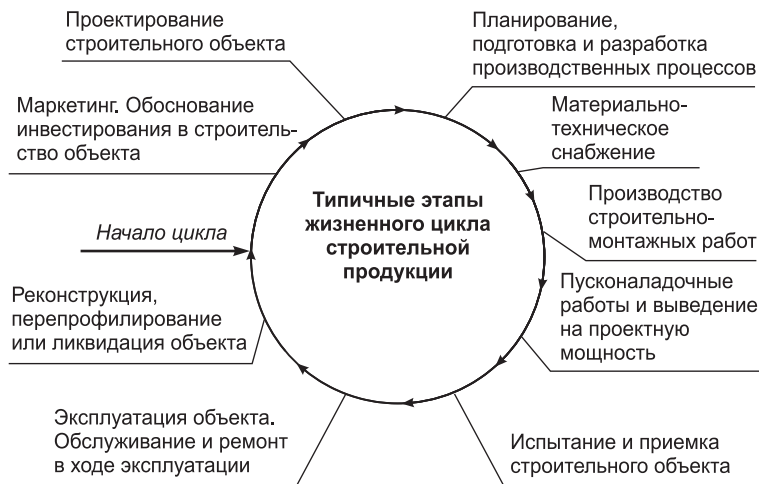
Рис. 4.1. Жизненный цикл строительной продукции
