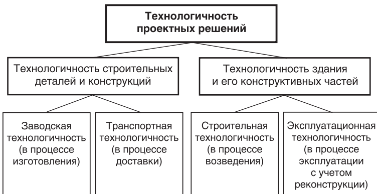
Рис. 5.13. Факторы строительной технологичности проектных решений
