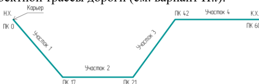
Рис. 1. Плановое расположение проектной трассы дороги
