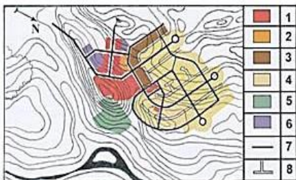
Рис. 4.4. Модель функционально-планировочной организации сельского населенного пункта: 1 – участки объектов общественного обслуживания; 2 – секционная жилая застройка; 3 – блокированная жилая застройка; 4 – коттеджная жилая застройка; 5 – участки зеленых насаждений общего пользования; 6 – участки производственных и коммунальных объектов; 7 – второстепенные жилые улицы; 8 – хозяйственные проезды
