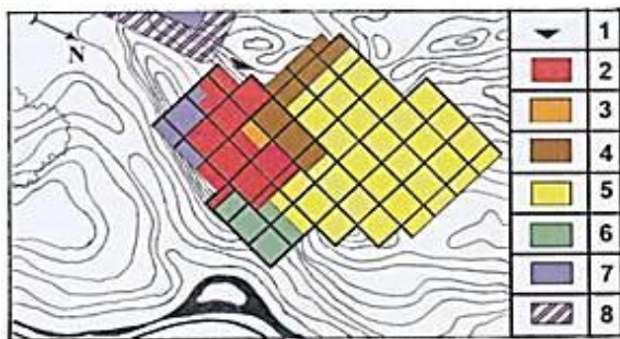
Рис. 4.2. Предпроектное функциональное зонирование территории: 1 – направление главного въезда в поселок; 2 – участки учреждений общественного обслуживания; 3 – многоквартирная жилая застройка; 4 – блокированная жилая застройка; 5 – застройка одноквартирными домами; 6 – парк; 7 – производственные и коммунальные объекты; 8 – санитарно-защитная зона
