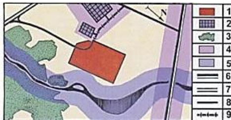
Рис. 2.5. Анализ планировочной ситуации: 1 – селитебная зона нового поселка; 2 – производственная территория; 3 – лесные массивы; 4 – санитарно-защитная зона; 5 – водоохранная зона; 6 – автодорога первой категории; 7 – автодорога второй категории; 8 – автодорога местного значения; 9 – направление главного въезда в поселок
