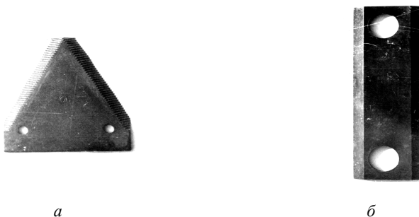
Рис. 3.8. Типы ножей: а – сегментный; б – молотковый
