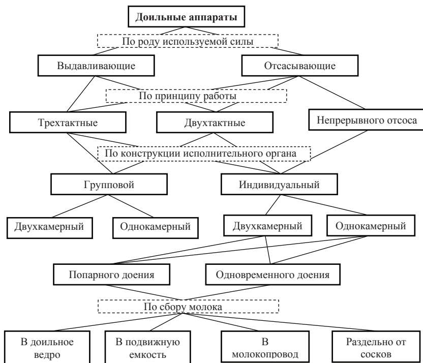
Рисунок 10.2 – Классификационная схема доильных аппаратов
