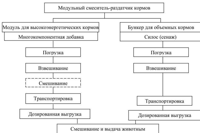
Рис. 4.13. Технологическая схема рабочего процесса мобильного модульного смесителя-раздатчика кормов
