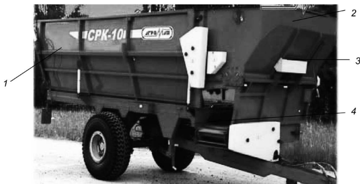
Рис. 4.11. Общий вид мобильного смесителя-раздатчика кормов: 1 – бункер для стебельчатых кормов; 2 – модуль для многокомпонентной высокоэнергетической добавки; 3 – дозирующая заслонка высокоэнергетической добавки; 4 – выгрузной цепочно-планчатый транспортер
