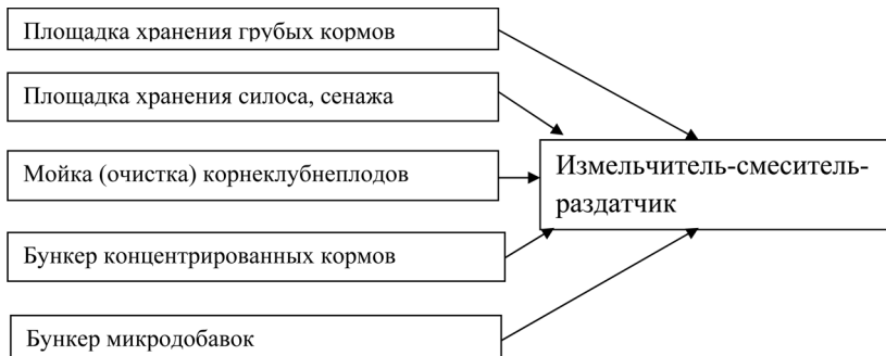
Рис. 4.10. Технологическая схема приготовления кормосмеси мобильным измельчителем-смесителем-раздатчиком, оборудованным весоизмерительным устройством и механизмом самозагрузки
