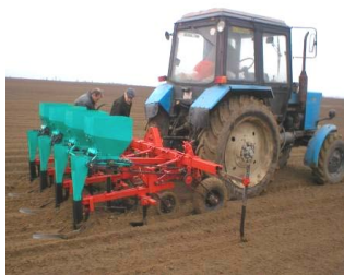
Рис. 15. Сеялка МПЛС-4 для посадки чеснока
