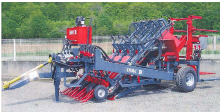
Рис. 16. Четырехрядный комбайн для уборки чеснока RE4 фирмы ERME
