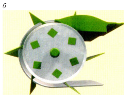
Рис. 17.2. Схема подборщика барабанного типа:
