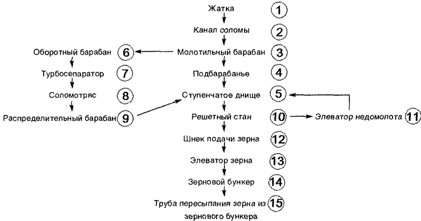
Рисунок 11.4 – Схема пути зерна через комбайн
