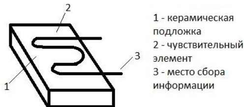
Рис. 11. Схема датчика выполненного в виде пленки: 1 – керамическая подложка; 2 – чувствительный элемент; 3 – место сбора информации
