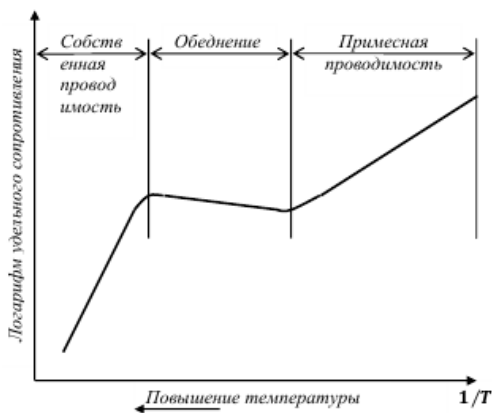
Рис.9. Температурная характеристика удельных сопротивлений германия и кремния в широком интервале температур
