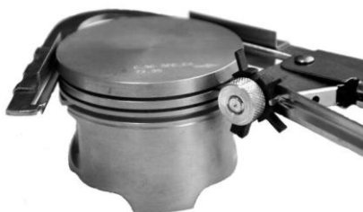
Рис. 5. Очистка поршневых канавок с помощью приспособления ( а ) и сломанным поршневым кольцом ( б )
