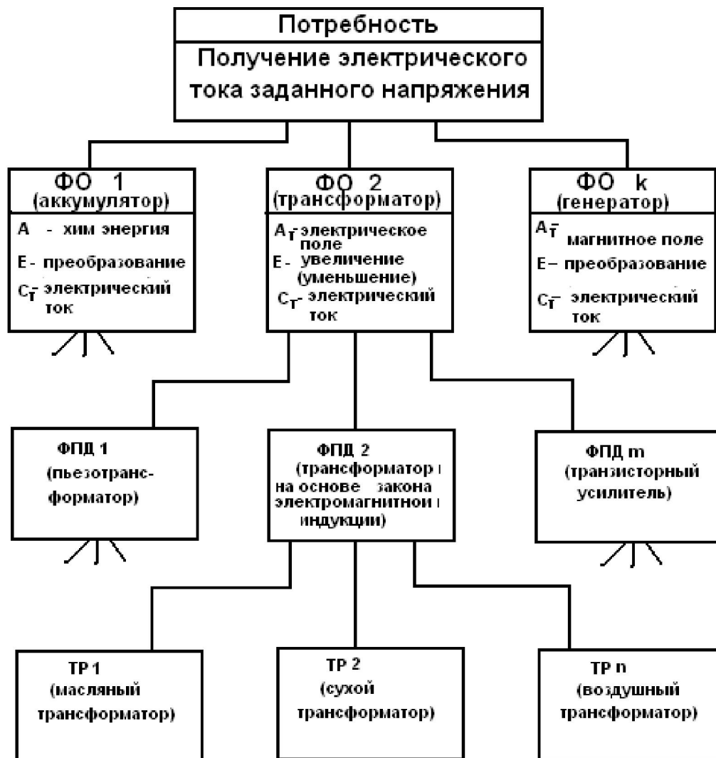
Рисунок 3 – Пример иерархии или систематики технического объекта
