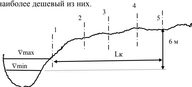
Рис. 6.3. Продольный профиль по трассе напорного трубопровода
