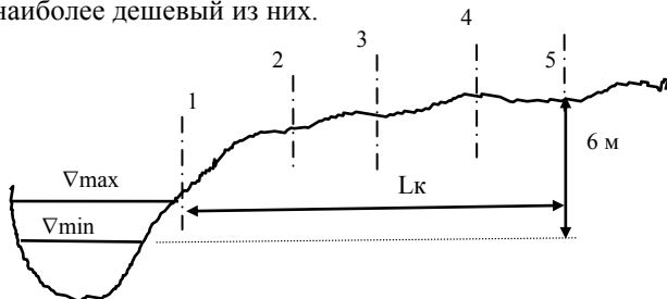
Рис. 6.3. Продольный профиль по трассе напорного трубопровода
