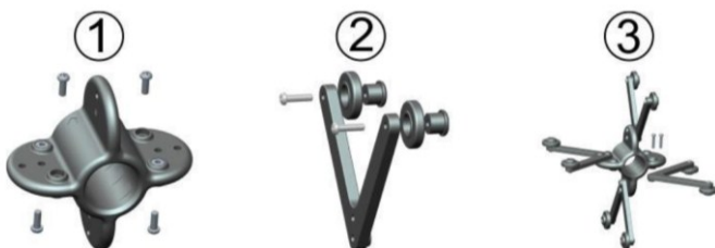
Рис. 22.6. Последовательность сборки и установки направляющих
