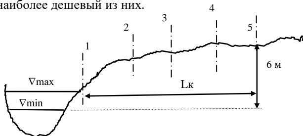
Рис. 6.3. Продольный профиль по трассе напорного трубопровода
