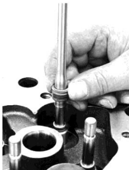
Рис. 20. Установка маслосъемного колпачка с помощью защитной гильзы
