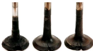
Рис. 1. Прогоревшие тарелки клапанов
