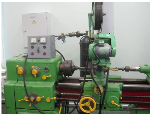
Рис. 3. Установка для наплавки деталей в среде \text{CO}_2
