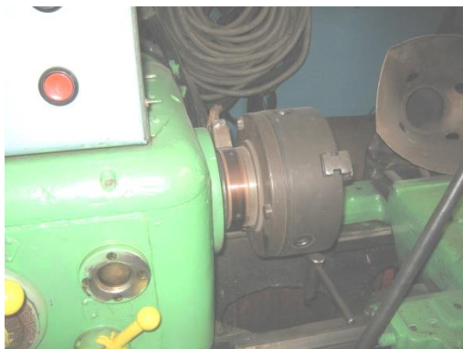
Рис. 4. Подвод сварочного тока к детали
