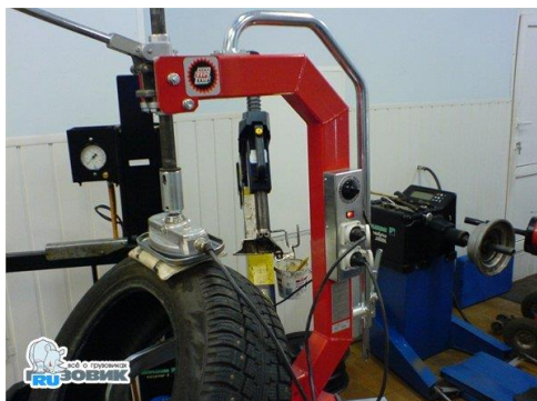
Рис. 8. Вулканизатор электрический для ремонта покрышек
