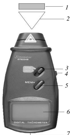
Рис. 12. Фототахометр DT6234B: 1 – отражающая метка; 2 – световой луч; 3 – кнопка «Измерение»; 4 – переключатель режима; 5 – кнопка «MEM»; 6 – дисплей; 7 – крышка отсека батареи
