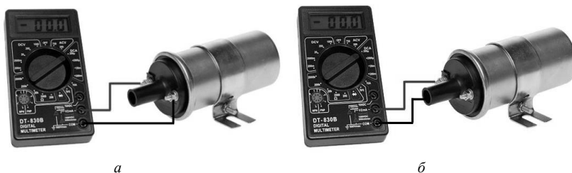
Рис. 3.2. Проверка исправности первичной (а) и вторичной (б) обмоток катушек зажигания замером их сопротивлений
