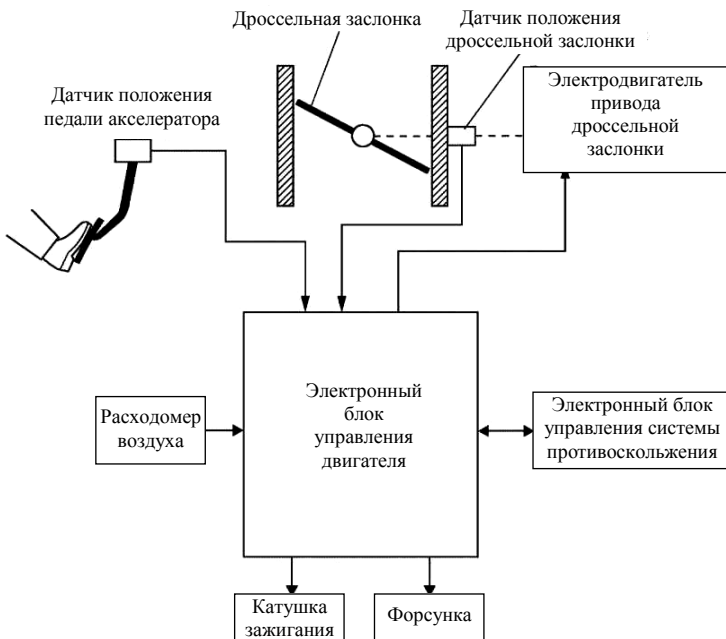
Рис. 4.4. Система управления подачей воздуха в камеру сгорания
