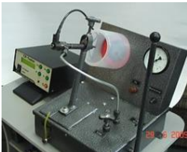
Рис. 5. Комплекс (СДФ + CR Tester) для проверки форсунок Common Rail
