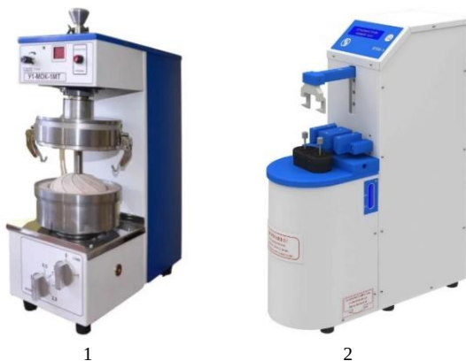
Рис. 17 Определение качества зерна (приборы): 1 – устройство для механизированного отмывания клейковины У-МОК-1МТ; 2 – прибор ПЧП-3
