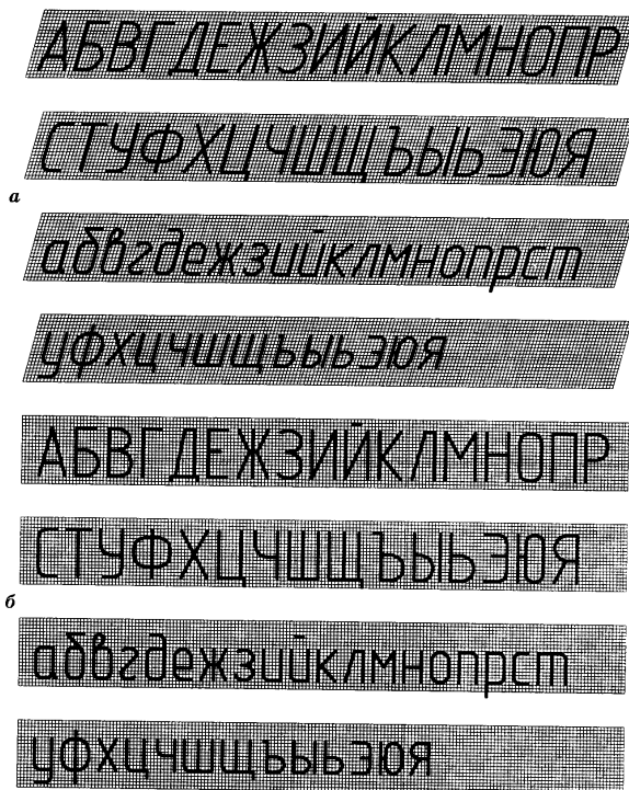
Рис. 6. Прописные и строчные буквы – шрифт типа А: наклонный и прямой
