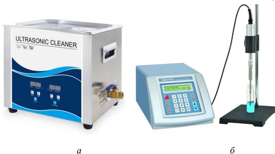
Рис. 6.8. Приборы для стерилизации ультразвуком: а – цифровая ванна «Sonicator»; б – ультразвуковой очиститель «Q125 Sonicator»
