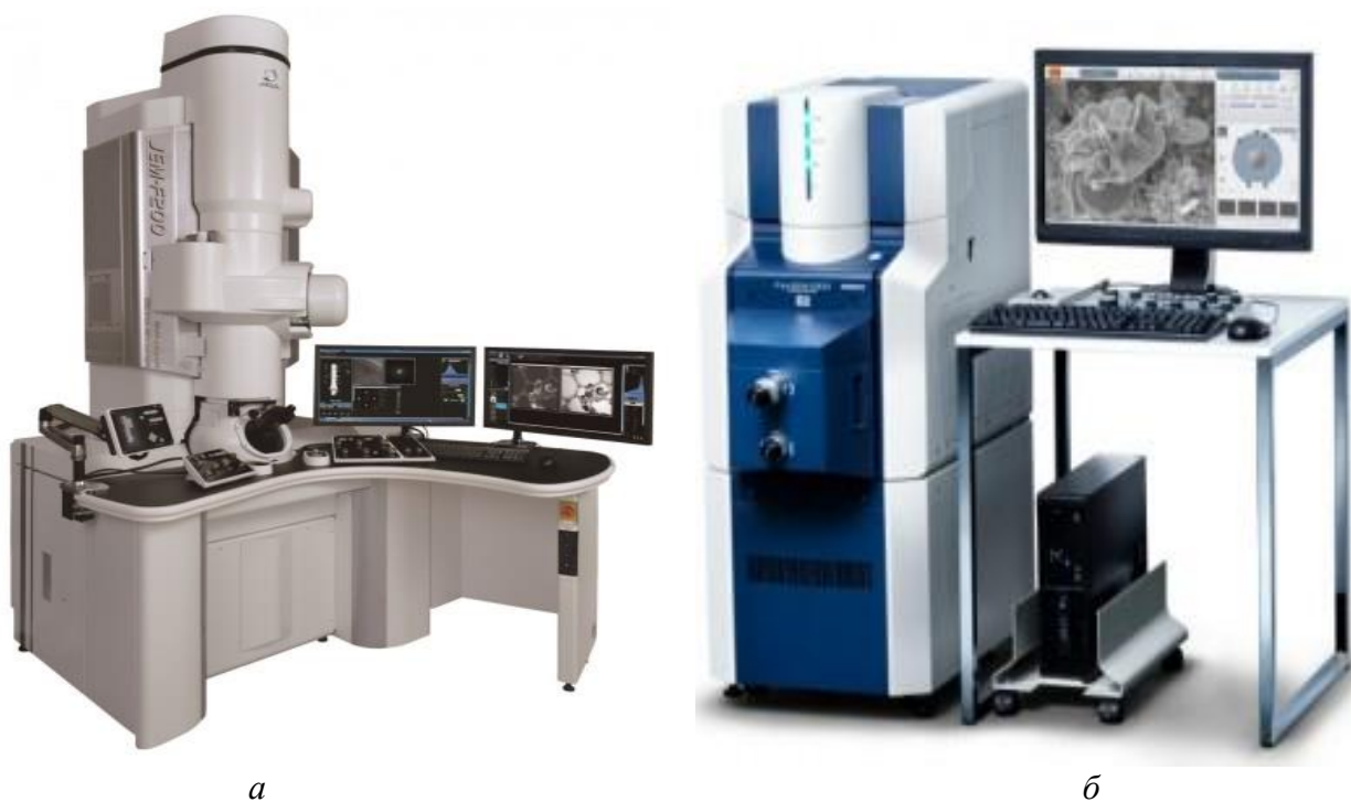
Рис. 1.7. Электронные микроскопы: а – микроскоп JEM-F200; б – сканирующий электронный микроскоп «FlexSEM 1000 Hitachi HT»
