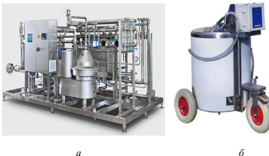
Рис. 6.6. Пастеризаторы для молока: а – пастеризационно-охладительная установка АСУ ТП; б – молочное такси
