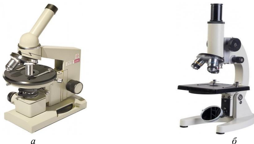
Рис. 1.2. Общий вид световых микроскопов: а – «Биолам Р-12»; б – «Микромед С-12»
