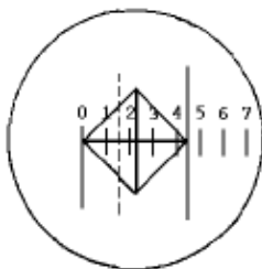
Рис. 8. Схемы измерения длины диагонали отпечатка на твердом теле ТП-2
