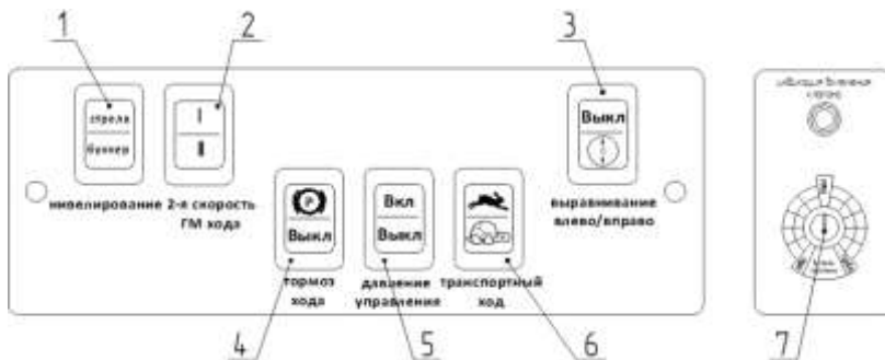
Рис. 4.3. Боковой пульт управления: 1 – клавиша включения нивелирования рабочим органом или трубоукладчиком; 2 – клавиша переключения I/II скорости транспортного хода экскаватора; 3 – включение корректировки прямолинейности хода (клавиша не задействована); 4 – клавиша включения стояночного тормоза; 5 – клавиша выключения давления управления экскаватором; 6 – клавиша переключения диапазона рабочего и транспортного хода экскаватора; 7 – управление прямолинейностью хода
