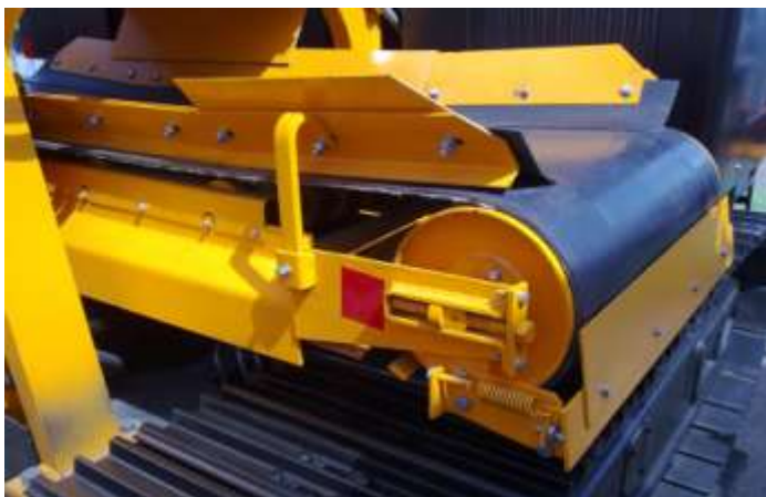
Рис. 4.9. Натяжной барабан с механизмом регулировки натяжения ленты
