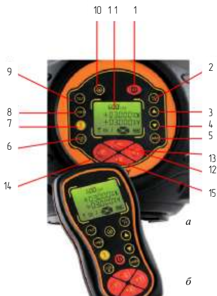
Рис. 4.27. Панель управления нивелиром (а) и дистанционный пульт (б): 1 – кнопка «вкл/выкл»; 2 – кнопка включения режима наклона; 3 – кнопка установки угла наклона вверх (процентов); 4 – кнопка установки угла наклона вниз (процентов); 5 – кнопка включения функции «спящий режим/ручной режим»; 6 – кнопка включения режима самовыравнивания/подсветка дисплея; 7 – кнопка выбора канала на пульте управления; 8 – кнопка включения режима защиты от вибрации и ветра (VWS); 9 – кнопка включения режима уклона (TILT); 10 – кнопка переключения скорости вращения; 11 – дисплей; 12–15 – кнопки выбора сектора
