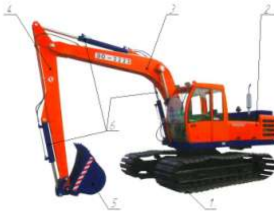
Рис. 4. Экскаватор ЭО-3223: 1 – ход гусеничный; 2 – платформа поворотная; 3 – стрела; 4 – рукоять; 5 – ковш; 6 – оборудование гидравлическое.
