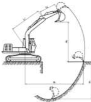
Рис. 6. Рабочие параметры экскаватора ЭО-3223.
