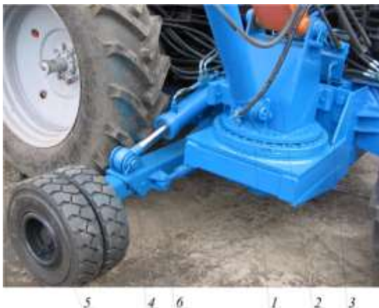
Рис. 7. Механизм поворота рабочего оборудования и дополнительная опора каналаочистителя ОКН-05
