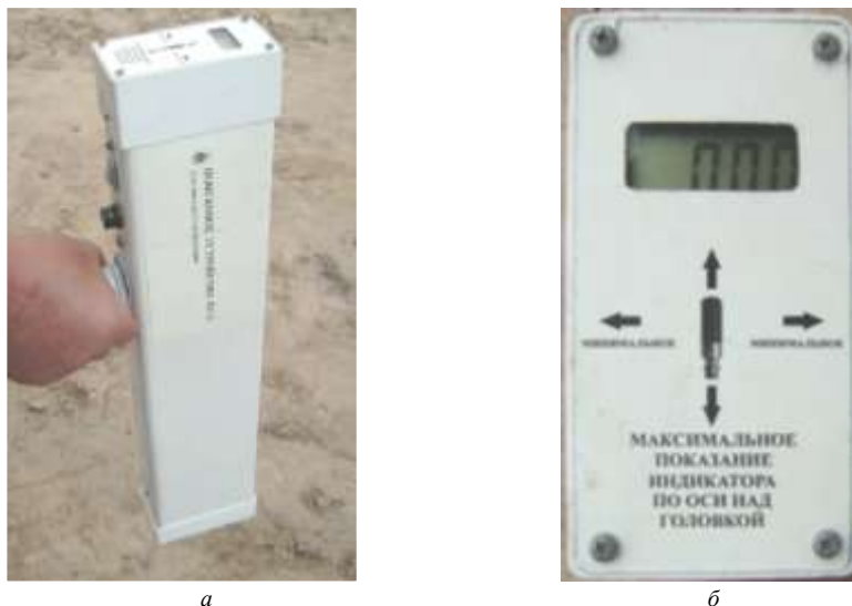
Рис. 11. Приемное устройство поискового комплекта трасс дренажных коллекторов ПУ-2: а – рабочее положение; б – лицевая панель с цифровым табло
