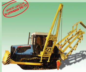
УРМ-4 на тракторе Агромаш-90ТГ с баровой установкой
