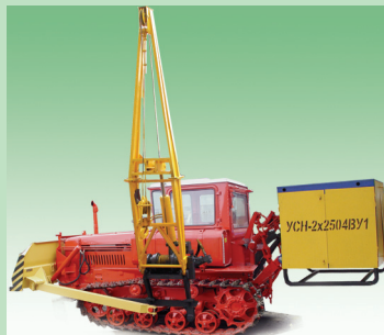
УРМ-4 на тракторе ДТ-75 со сварочной установкой
