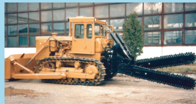
Баровая грунторезная машина БР-00/БР-01 производства ОАО "Михневский РМЗ"
