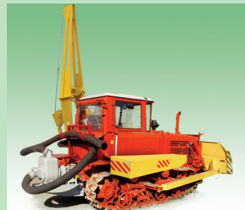
УРМ-4 на тракторе ДТ-75 с водоотливной установкой
