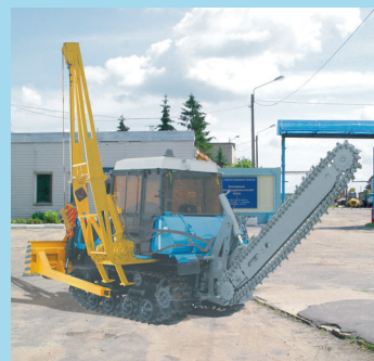
Траншейный экскаватор МЗЦ-75 производства ОАО "Михневский РМЗ" на новом тракторе "Агромаш 90 ТГ"
