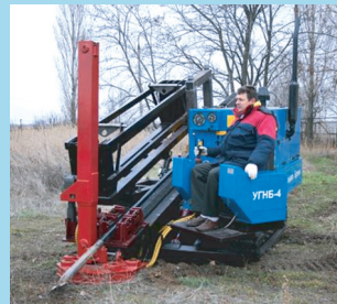
Установка горизонт. бурения УГБН-4
