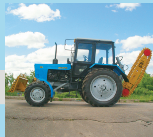
Баровая грунторезная машина БГМ-1 производства ОАО "Михневский РМЗ"
