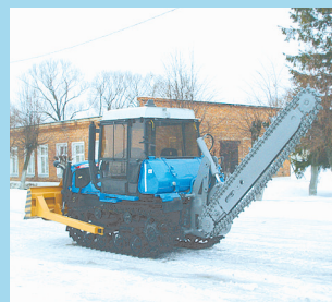
Машина землеройная МЗЦ-75 производства ОАО "Михневский РМЗ" на новом тракторе "Агромаш 90 ТГ"
