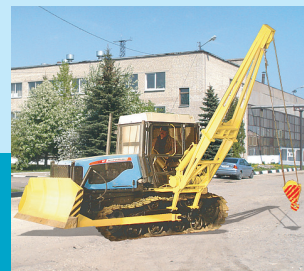
Универсальная ремонтная машина УРМ-4 производства ОАО "Михневский РМЗ" на новом тракторе "Агромаш 90 ТГ"
