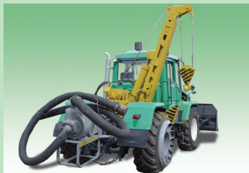
СМР-3,2 с водоотливной установкой
