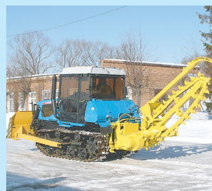
Траншейный экскаватор ЭТЦ-75 производства ОАО "Михневский РМЗ" на новом тракторе "Агромаш 90 ТГ"
