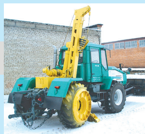
Строительно-ремонтная машина СМР-3,2 производства ОАО "Михневский РМЗ" на новом тракторе ХТА
