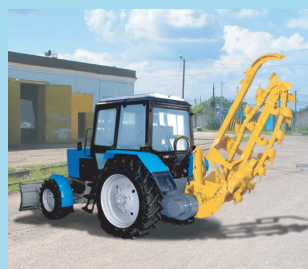
Баровая грунторезная машина БГМ-2У производства ОАО "Михневский РМЗ"
