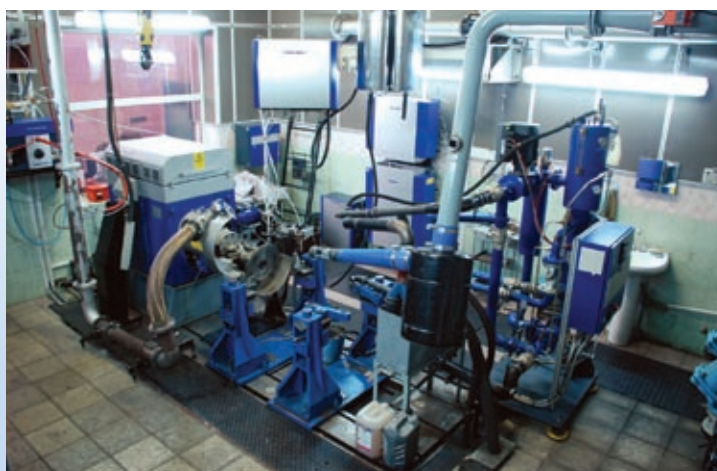
Испытательный стенд с системой автоматизации PUMA, AVL, Австрия Test bench with automation system PUMA, AVL, Austria
