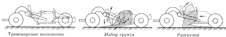
Рисунок 11.4 – Рабочий цикл скрепера
