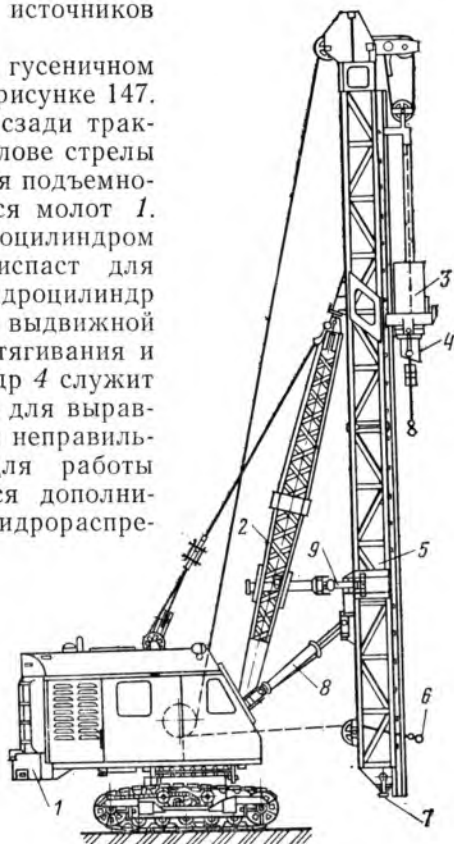
Рис. 148. Копер на базе экскаватора:
