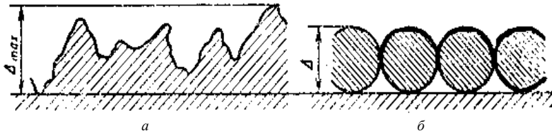
Рис. 10.5. Естественная (а) и эквивалентная зернистая (б) шероховатости
