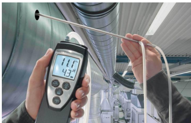
Рис. 14. Анемометр Testo 512 дифференциального давления с трубкой Пито
