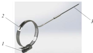
Рис. 9. Устройство датчика температуры возвратного контура:
