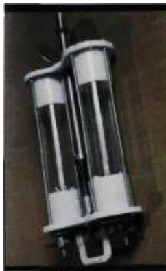
8.2. Батометр с двумя цилиндрами
