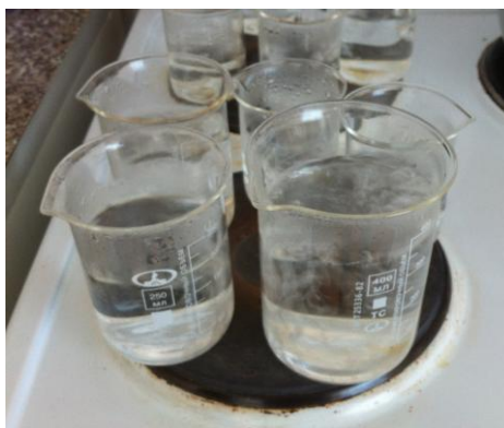
Рис. 8.12. Кипячение дистиллированной воды до уменьшения объема на \frac{1}{3}
