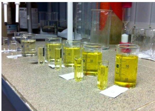
Рис. 8.13. Изменение цвета пробы при добавлении раствора виннокислого калия-натрия и реактива Несслера
