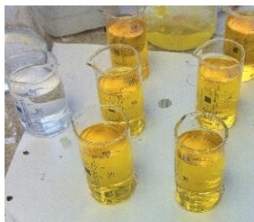
Рис. 8.45. Окрашивание пробы спустя 10 мин после добавления 7 см 3 10 н. раствора едкого натра (при большом количестве нитратов в воде)
