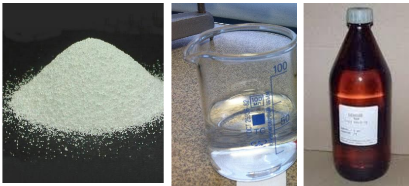
Рис. 8.11. Компоненты для приготовления раствора виннокислого калия-натрия: a – виннокислый калий-натрий ( C_4H_4KNaO_6 \cdot 4H_2O ); б – безаммиачная дистиллированная вода; в – реактив Несслера
