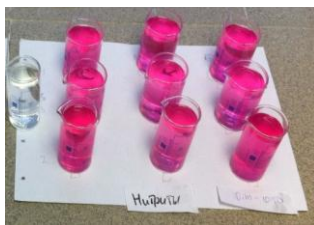
Рис. 8.34. Пробы воды спустя 40 мин после добавления 2 см 3 раствора реактива Грисса
