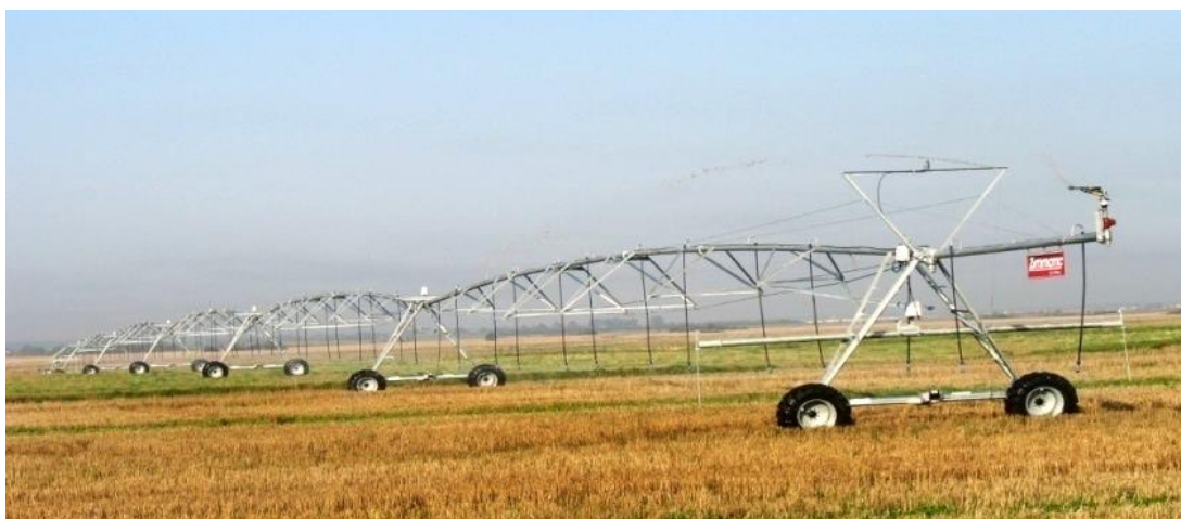
Рис. 7.2. Конструктивная схема широкозахватных дождевальных машин типа «Днепр», «Фрегат», «Кубань»
