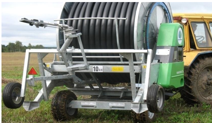
Рис. 7.1. Общий вид шлангового дождевателя с дальнеструйным дождевальным аппаратом
