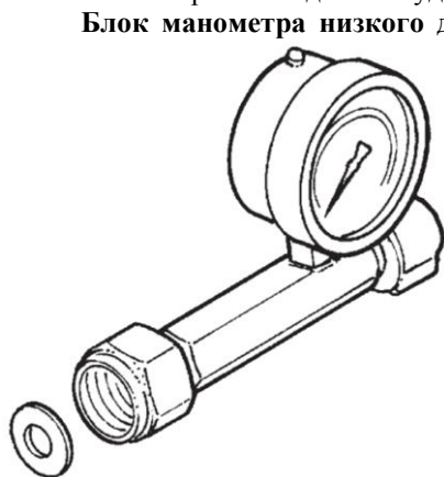
Рис. 10. Блок манометра низкого давления
