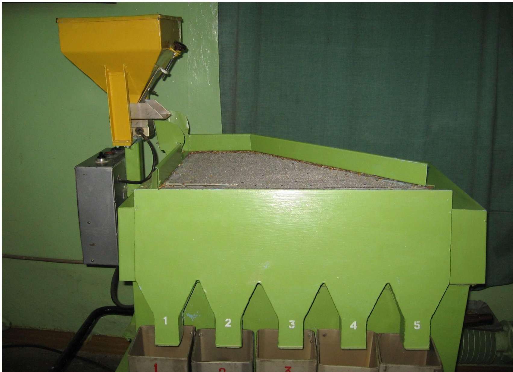
Лабораторная установка для изучения процесса разделения зерна на пневматическом сортировальном столе
